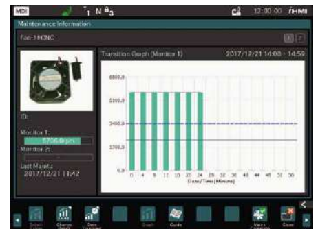
Fan monitor screen
