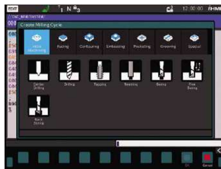
iHMI Machining Cycle
